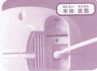
本体底面の DC プラグ差込口に、専用 AC アダプタの DC プラグを接続します。
